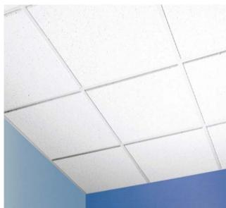
Los techos de fibra mineral están compuestos por celulosa, almidón, fibras textiles, aditivos y aglutinantes. Instalar este tipo de solución (siempre en función de la densidad) bajo un forjado mejora la absorción acústica y disminuye el nivel sonoro global. Los techos de fibra mineral aúnan una buenas prestaciones acústicas, tanto en absorción como en atenuación.
