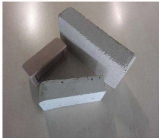
Los ladrillos puzolánicos incorporan en su composición residuos de procesos industriales, como el Filler de Aluminio y las Cenizas Volantes de Carbón, con aditivos habituales como el cemento y la cal, y sin necesidad de cocerlos, puesto que se originan en ambientes controlados reacciones puzolánicas exotermicas.
