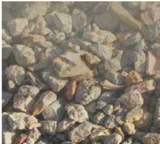
El árido reciclado es el material granular resultante del tratamiento de materiales inorgánicos utilizados previamente en la construcción, siendo el principal producto de valorización de la parte pétreo de los Residuos de Construcción y Demolición.
