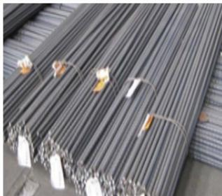
Los productos de acero que pueden emplearse para la elaboración de armaduras pasivas pueden ser barras rectas o rollos de acero corrugado soldable, alambres de acero corrugado o grafilado soldable o alambres lisos de acero soldable. Los tipos de acero normalizados son los siguientes:
