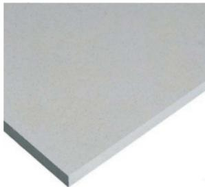
Placas de yeso laminado es el nombre genérico oficial que engloba una amplia familia de productos de características similares. Se componen de un núcleo interior formado por una placa de yeso laminado y dos capas (delantera y trasera) de cartón (celulosa) de acabado natural en la cara frontal y de un papel duro en la parte posterior.
