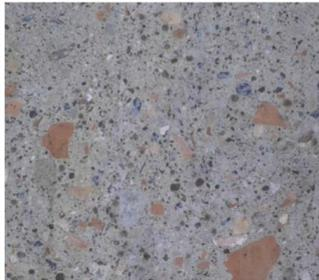
El árido reciclado es el material granular resultante del tratamiento de materiales inorgánicos utilizados previamente en la construcción, siendo el principal producto de valorización de la parte pétreo de los Residuos de Construcción y Demolición.
