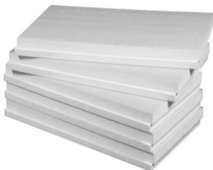
El poliestireno extruido (XPS) es una espuma rígida, aislante, de carácter termoplástico y de estructura celular cerrada. Se fabrica a partir de resina de poliestireno y una serie de aditivos. Esta mezcla se introduce en la extrusora para su fusión. Posteriormente, se inyecta un agente espumante para su expansión y se da forma a los paneles.
