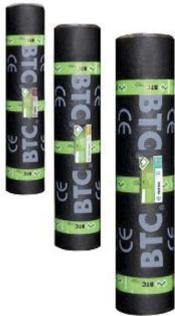
Las láminas asfálticas están formadas por dos capas de recubrimiento asfáltico -betún modificado con polímeros y carga mineral-, separadas por una armadura, -habitualmente de fibra de vidrio o fieltro de poliéster- que garantiza su estabilidad y propiedades mecánicas preservando a la vez la flexibilidad del producto.
