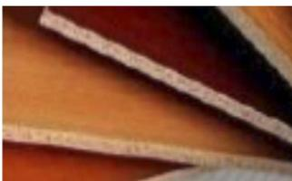
Muchos de los tableros de madera no maciza utilizados en construcción tienen un alto porcentaje de madera reciclada utilizada en su composición.
