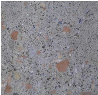
El árido reciclado es el material granular resultante del tratamiento de materiales inorgánicos utilizados previamente en la construcción, siendo el principal producto de valorización de la parte pétreo de los Residuos de Construcción y Demolición.
