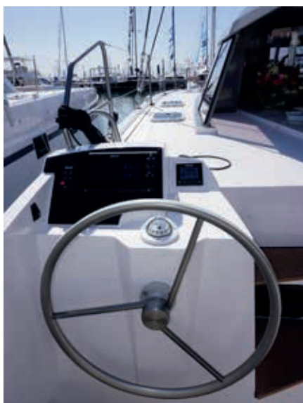
Système double barres simple safran, avec appareils sur cloison Double bar single rudder system, with devices on bulkhead
