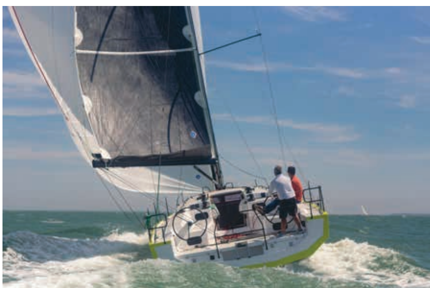
Système double barres double safrans, avec colonnes de barre Double bar system double rudder, with bar columns
